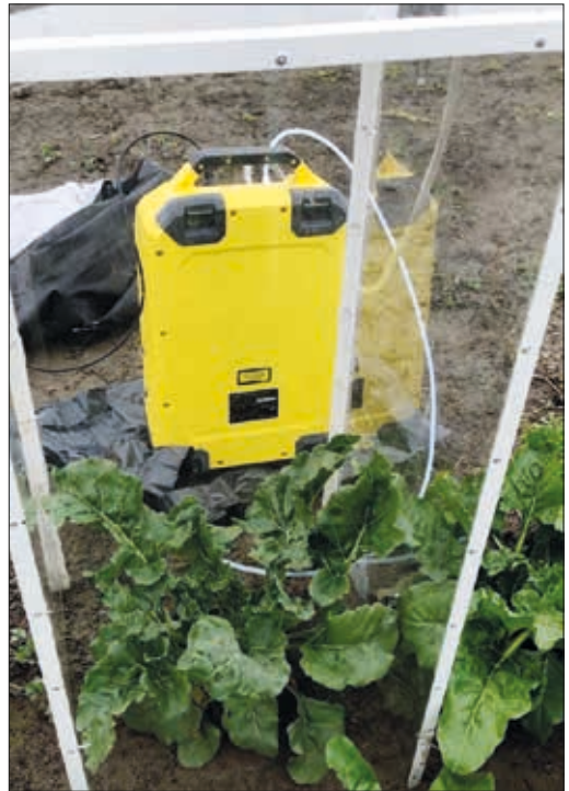
Kuva 1. Läpinäkyvä mittauskammio, jonka sisällä on yksi juurikas. Taustalla keltainen Gasmeter GT 5000 Terra-mittari, joka mittaa kammioista \text{CO}_2 , \text{CH}_4 , \text{N}_2\text{O} , \text{NH}_3 ja \text{CO} -kaasujen pitoisuuksia (ppm). Mittausajat vaihtelivat 10–15 minuuttia.
